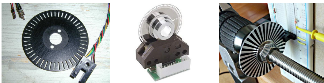
Figuur 3.2: Encoderschijf met light gate. De light gate bevat in één been een IR-LED en in het ander been een fototransistor (transistor die in geleiding gaat onder invloed van licht) of een LDR (weerstand waarvan de waarde afneemt onder invloed van licht (links) en een volledige assembly incl. lichtsensor en connector op PCB (midden en rechts).
